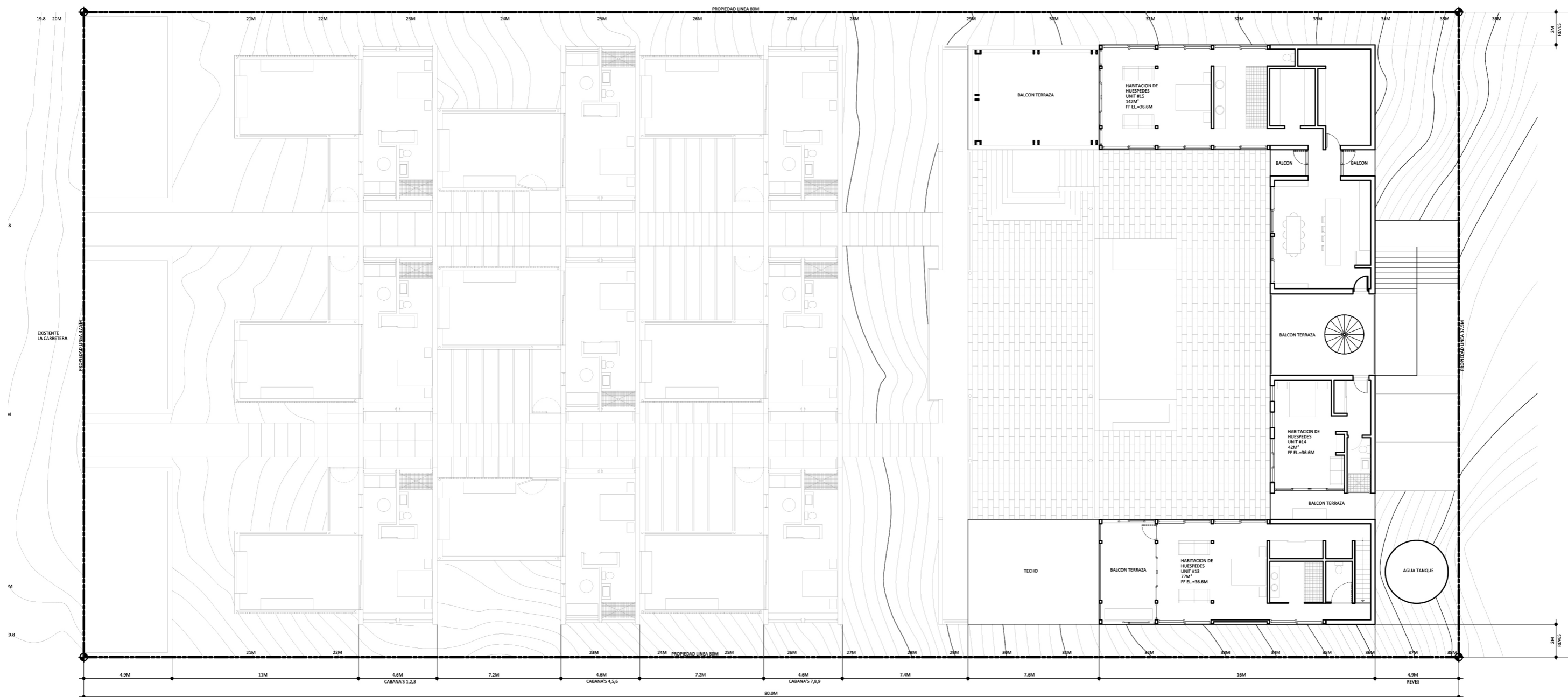
SITIO PLAN - NIVEL 7 - HABITACION DE HUESPES UNITS 13,14,15 - ELEVACION 36.6M - TOTAL M =261M 2
